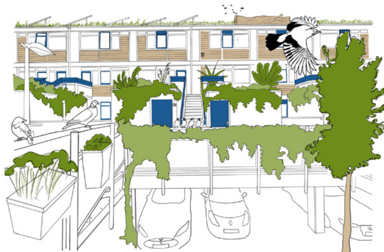
De woondekken kunnen vergroend worden op vele manieren: zonnepanelen op de platte daken, voorzien van begroeiing en nestgelegenheid voor insecten en vogels, bloembakken en bomen op de binnenplaats, begroeiing van de platte daken van de vele schuurtjes.
